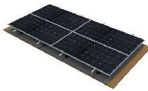
中間、端部押え金具を取付、設置完了
